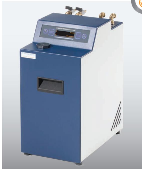
Was die Versorgerseite für den Kühler betrifft, kann dieses ein Hauswasserkühlkreis sein oder auch die Trinkwasserleitung. Das Gerät nimmt nur soviel Wasser ab wie notwendig ist, um die Kälteleistung zu erfüllen.
